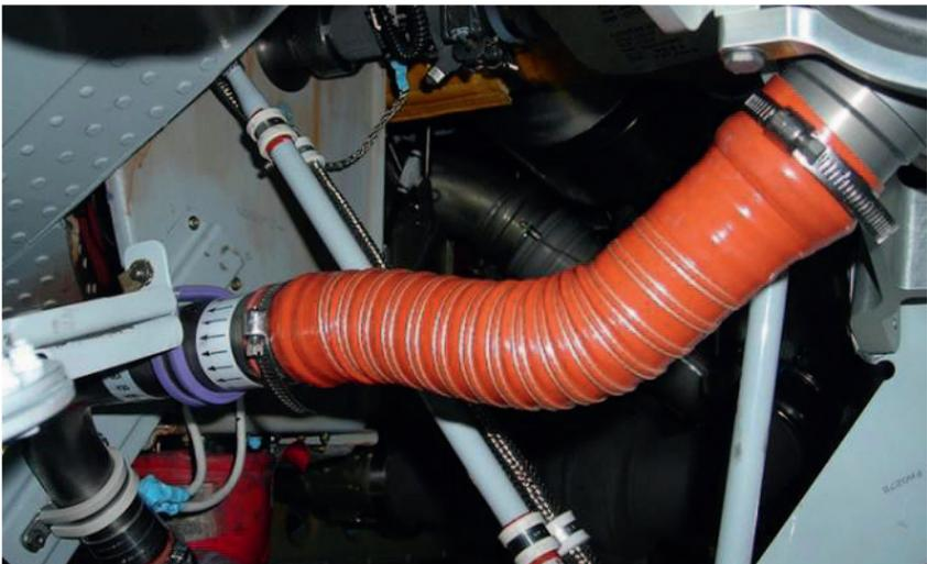
*Elektrisch leitfähiger Belüftungsschlauch im Tanksystem eines Flugzeuges, der auch elektrostatische Aufladung ableitet*
