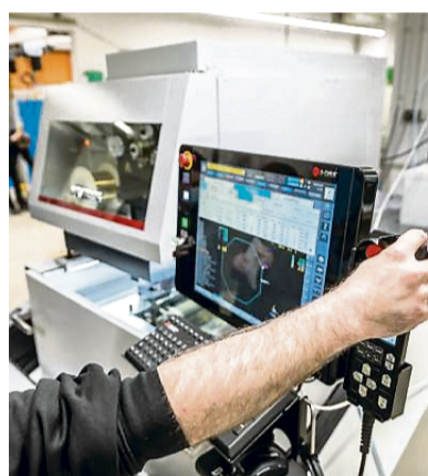
Mittels Drahterodieren entstehen präzise Spritzgussformen.
